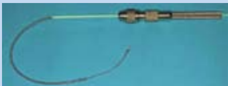
Kuva 2. Poistoholkki (vihreä) pujotettu poistettavan johdon päälle.
